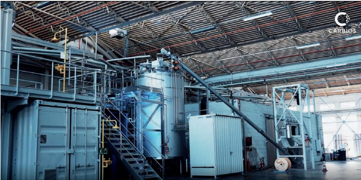
Réacteur d'hydrolyse enzymatique pour la dépolymérisation des déchets plastiques et textiles PET en monomères (crédit : Carbios)
